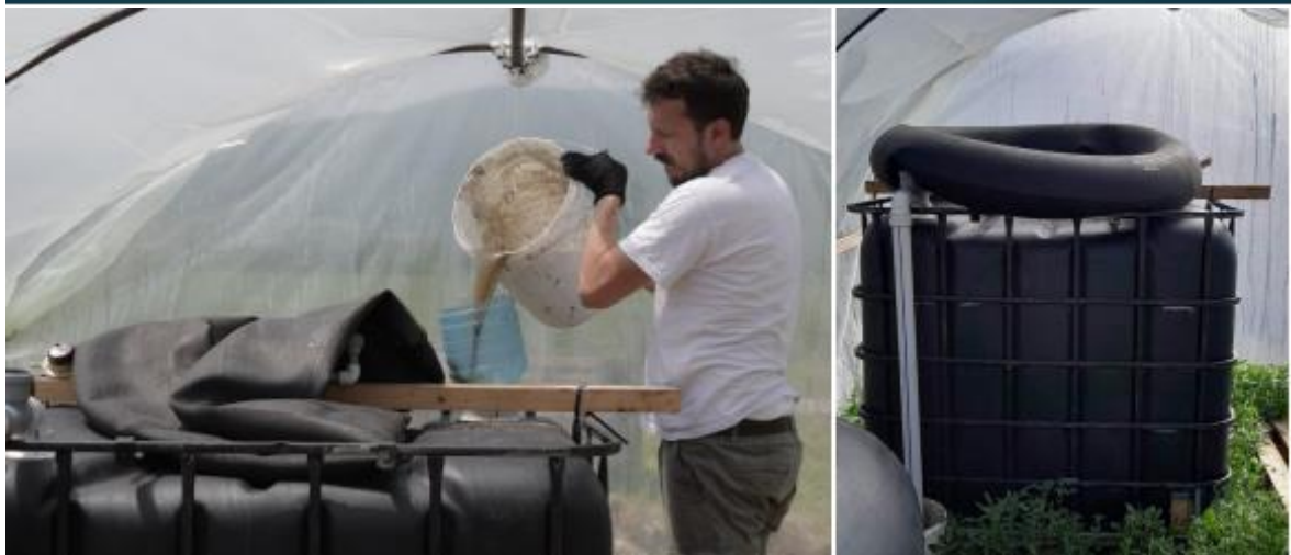
Слика 2. Шема на поставеност на мала биогазна централа и полнење на биогазна централа (извор АКОРН во партнерство со УКИМ-ФЗНХ)
