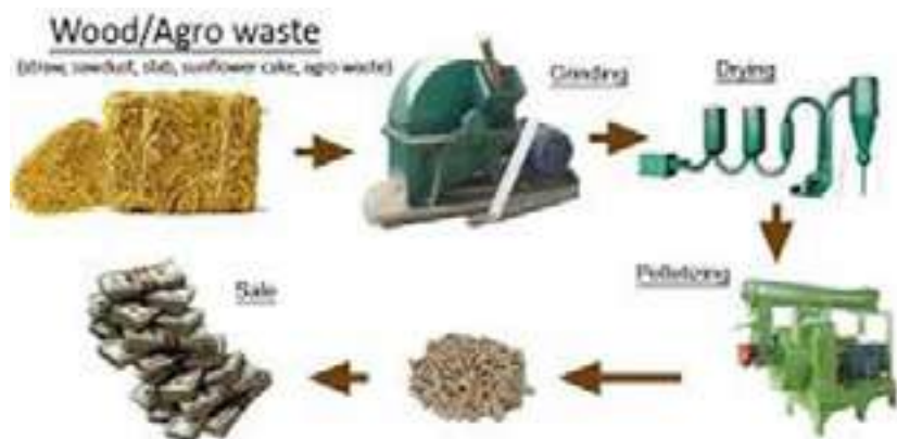
Figura 1: Pasqyra skematike gjatë prodhimit të peletave
