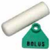
Слика2. Електронски болус со ушна маркичка
