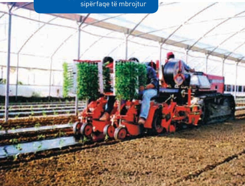
Makina për mbulim dhe mbjelljen e drejtpërdrejtë të fidanëve në sipërfaqe të mbrojtur
