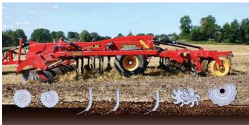
Комбиниран апарат за инкорпорирање на сламата
