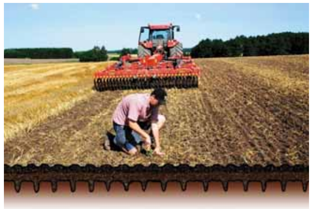
Дисков култиватор за инкорпорирање на сламата
