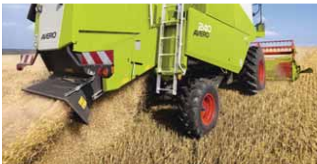
Уред за сечкање на слама кај жиџен комбајн
